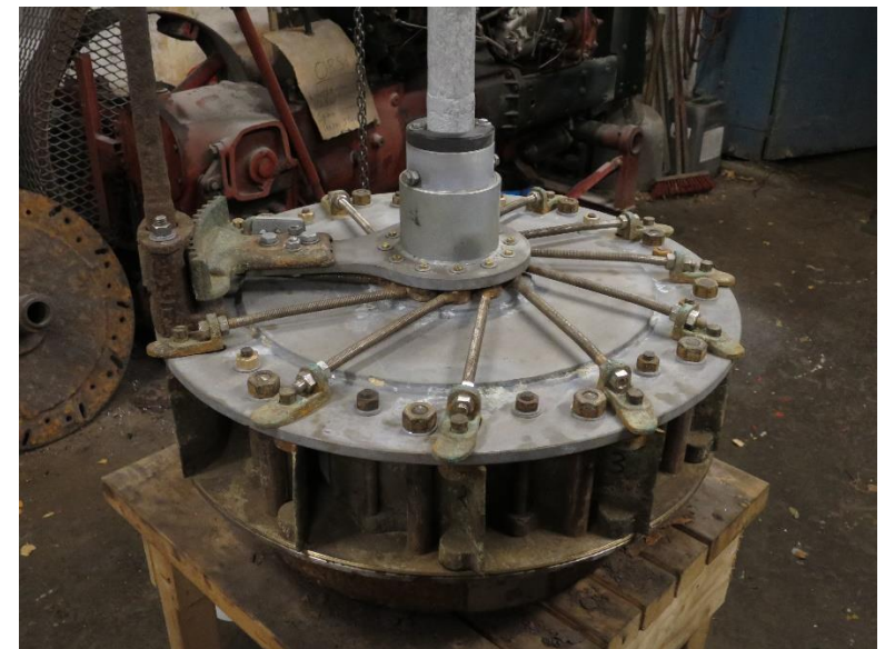
Turbinen klar för montering.
